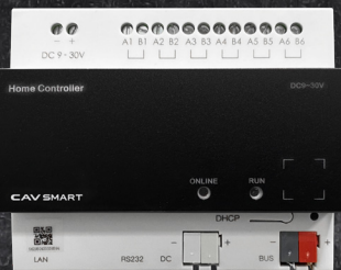
空调直连网关 支持对接市场95%以上中央空调品牌
