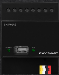
边缘AI主机 控制中心，协调各智能设备的运行
