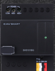
RS485协议模块 转换信号为485信号，与第三方485设备通讯
